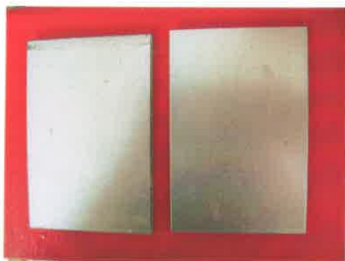
Obrázek č. 2 – Porovnání vrchní strany pozinkovaného plechu po expozici(nalevo) s etalonem
