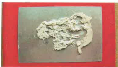
Obrázek č. 4 – Pozinkovaný plech s lepidlem po expozici
