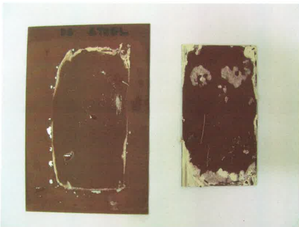
Obrázek č. 7 – Pozinkované plechy po odtržení a omytí vodou po expozici v komoře
